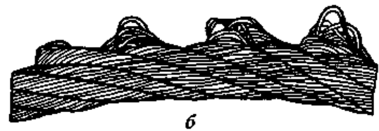
Рис.19 – Выдавливание проволок прядей: а — в одной пряди; б — в нескольких прядях
