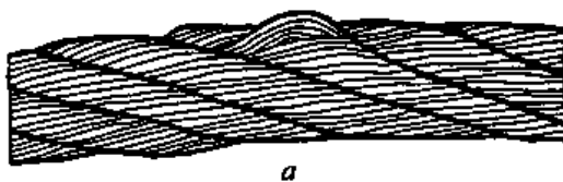
Рис.19 – Выдавливание проволок прядей: а — в одной пряди; б — в нескольких прядях
